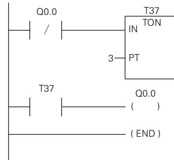
用常闭触点 Q0.0 代替定时器位 (T 位) 作为定时器的使能输入，在一次扫描后定时器达到预定值时可保证接通输出 Q0.0。
