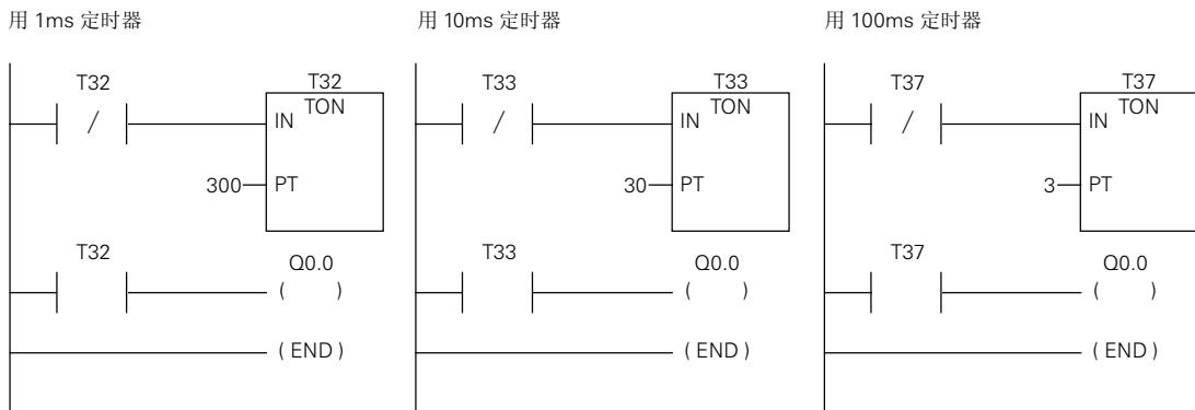
在使用 1ms 定时器的情况下，无论常开触点 T32 执行前或常闭触点 T32 执行后，每当更新定时器当前值，一次扫描将接通 Q0.0。
