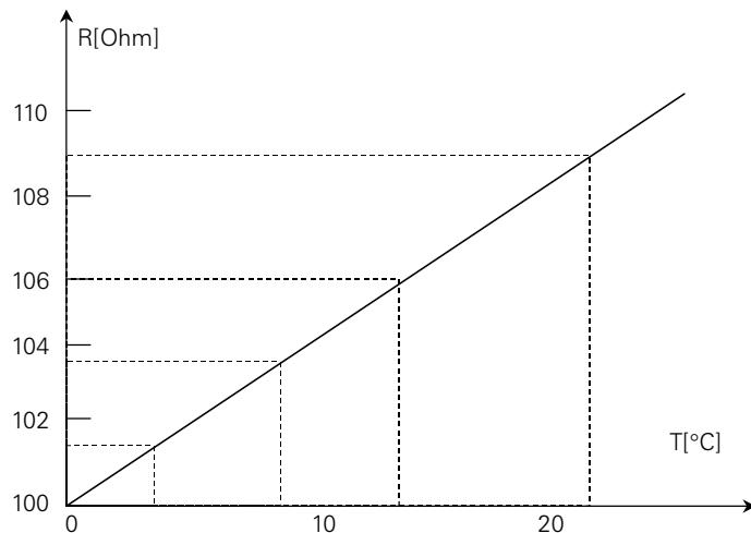
为了产生  $5\text{mV}/^{\circ}\text{C}$  的电压系数，需要提供  $12.5\text{mA}$  电流。由于模拟量输出精度为  $10\mu\text{A}$ /数，为了得到  $12.5\text{mA}$  输出电流所需的输出数必须为 1250。因为 AQW 数据字向右移 4 位，因此输出数必须乘以 16。这样，为了初始化模拟量输出 Io 为  $12.5\text{mA}$  电流，在 AQW0 中必须设置 20000 输出数。
