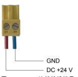
图 4-7 连接接线端子
