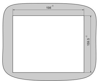
图 3-3 HMI 设备的安装开孔
