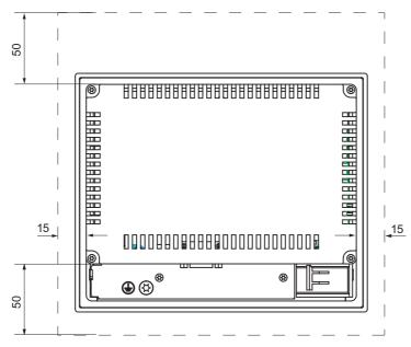
图 3-4 HMI 设备周围的空隙
