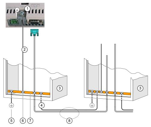
图 4-3 安装等电位电路
