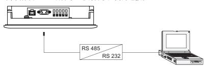
图 4-5 连接组态计算机
